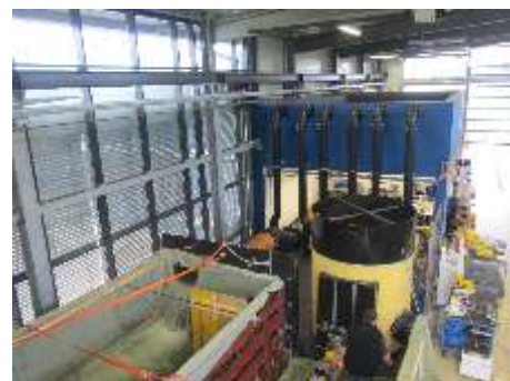
Situationsnachbau eines Sandfangs Simulation des Lufteintrags
