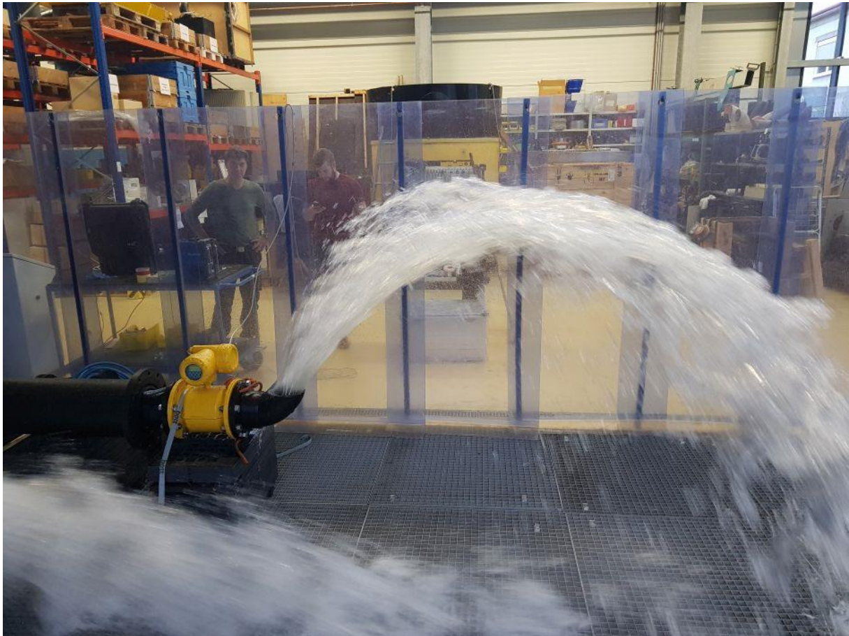
ABBILDUNG 1: BEISPIEL EINES SICHERHEITSGERÄTES AUF DEM PRÜFSTAND BEFINDLICHEN MID
