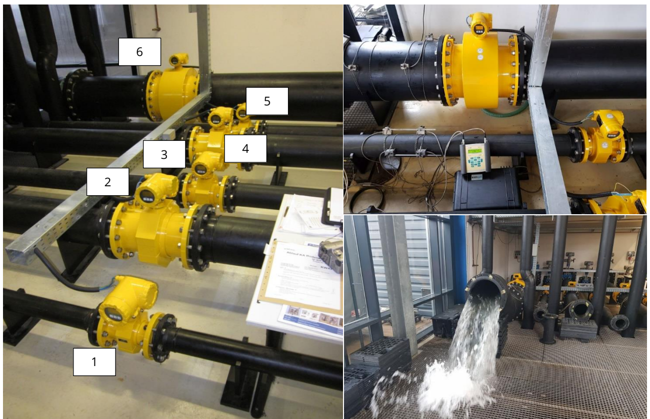
ABBILDUNG 2: MID DES PRÜFSTANDES (LINKS) VERGLEICHSMESSUNG – EXEMPLARISCH (RECHTS)
