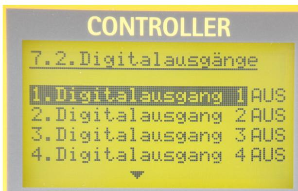
Die Digitalausgänge können in diesem Menü EIN und AUS geschaltet werden um die Funktion dieser zu überprüfen und um Stör- und Statusmeldungen zu simulieren.
