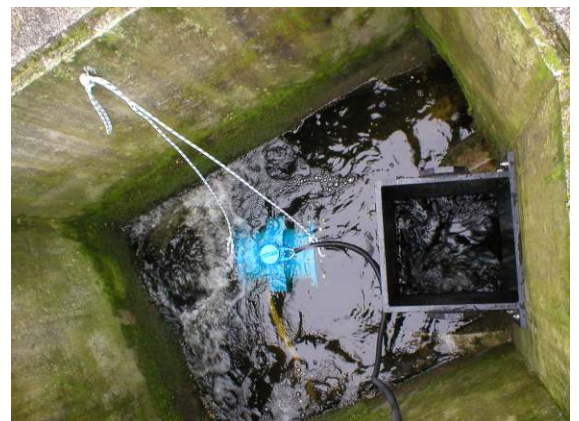
Perma-DiK System als IP 68 Version misst auch Unterwasser
