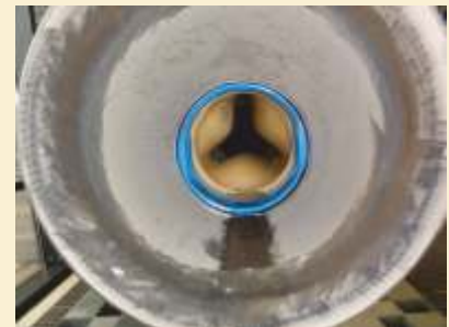
Anaconda-Ventil (DN 300-400) fast geschlossen. Es bleibt bis zum Schluss oben und unten offen, damit Luft und Geschiebe durchgelassen werden.
