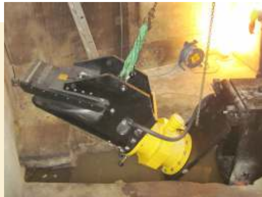
Alligator DN 200 mit Umlenkkasten geöffnet durch hochklappen
